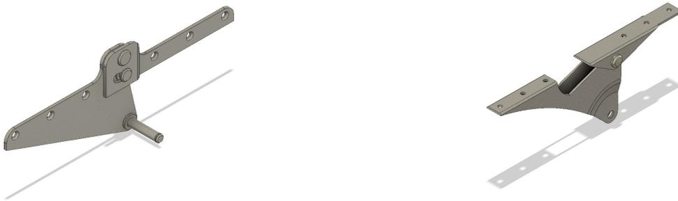
Lo studio delle dinamiche delle leve garantisce una struttura molto affidabile e ne impedisce il "ribaltamento" quando viene applicato un carico sull'estremità della testiera. Molte altre meccaniche per reti a cinque sezioni, se azionate senza la persona coricata, rimangono con la schiena allineata alla cervicale, per poi scattare in posizione corretta una volta che l'utente ci si sdraia (con immaginabili disagi per l'utente).
